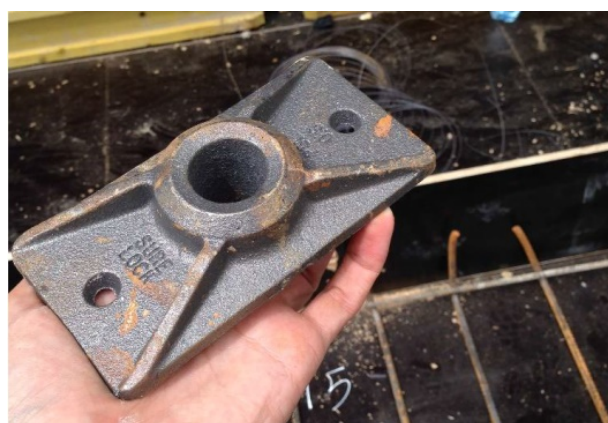
الف) گیره کششی و قالب حفره ی جلوی گیره در سیستم نچسبیده
