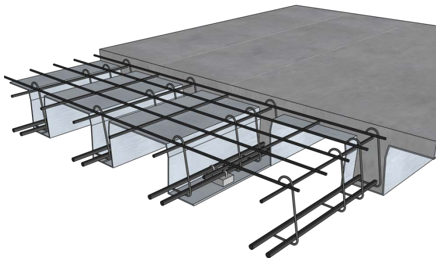
شکل ۶-۱۵- تصویر شماتیک از دال مجوف با تیرچه‌های یکطرفه
