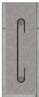
شکل ۸-۲۳- نمونه ای از اجرای تیر بنایی مسلح
