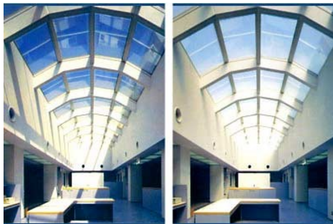
شکل ۱۲-۷۲- نمونه پوشش شفاف سقف با شیشه‌های فتوکرومیک
