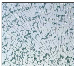
شکل ۱۲-۸۳- شکست در شیشه با عملیات حرارتی کامل
