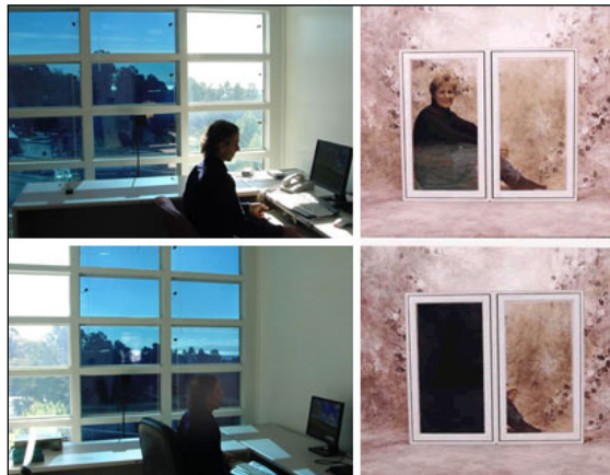
شکل ۱۲-۷۵- نمونه عملکرد پنجره‌های با شیشه‌های الکتروکرومیک
