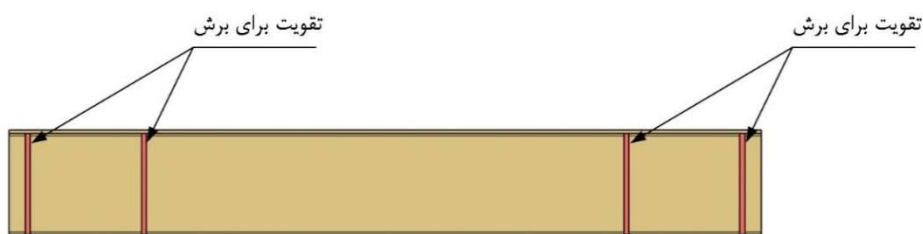
شکل ۱۴-۷۴- ورق سخت‌کننده عمود بر صفحه جان تیر
