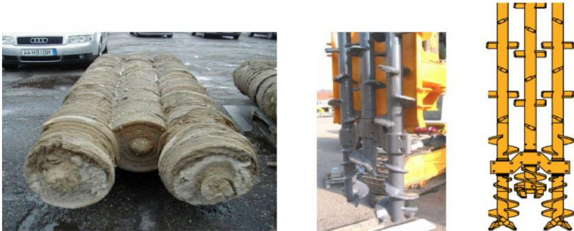
شکل ۳-۶۶ ماشین اختلاط عمیق خاک، که دارای سه مته جهت ترکیب خاک و دوغاب سیمان است و ستون‌های خاک سیمانی به شکل سه دایره دارای همپوشانی تشکیل می‌دهد.
