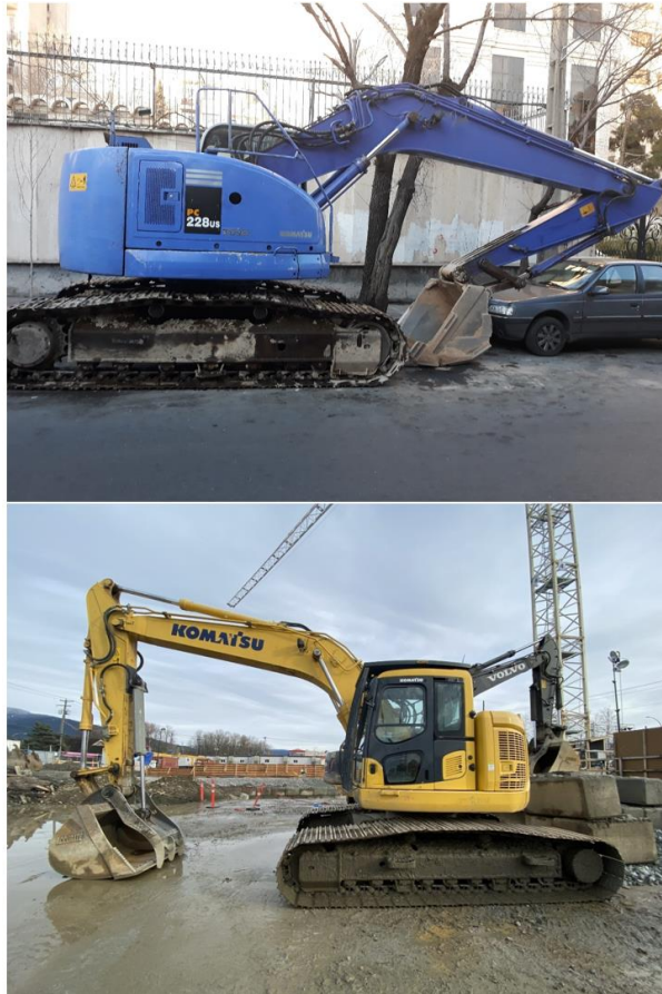
شکل ۳-۷۵ بیل مکانیکی با فرم خاص برای کار در شرایط محدودتر
