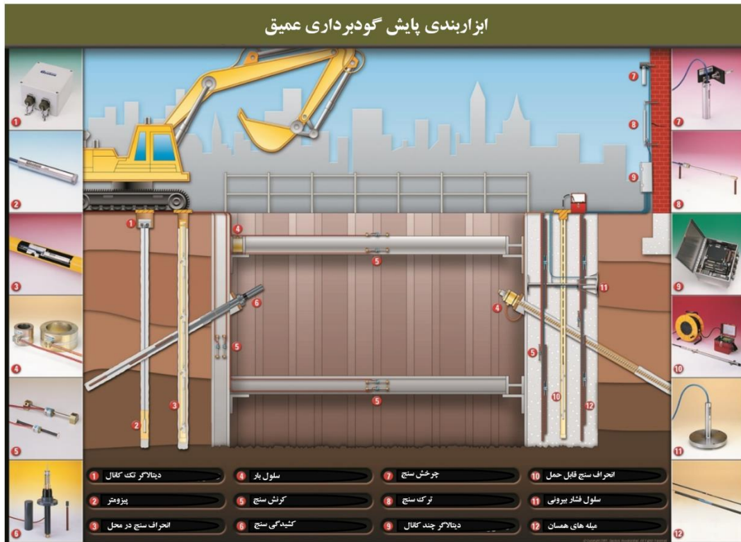
شکل ۵-۸ تصویر شماتیکی از ابزاربندی و رفتارسنجی گودهای عمیق شهری و ساختمان‌های مجاور
