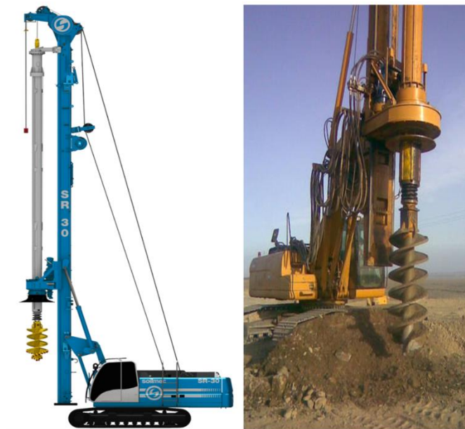
شکل ۳-۲ یک نمونه دستگاه حفار روتاری (دورانی) شمع.
