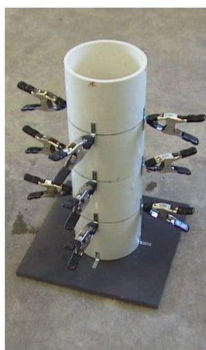
شکل ۹-۳ آزمایش ستون جدادگی مطابق روش ICAR
