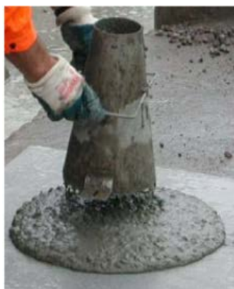
شکل ۲-۳ انجام آزمایش جریان اسلامپ
